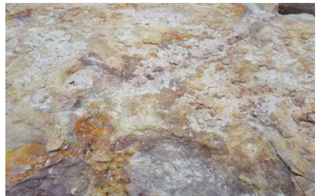
Рис. 6. Бугристая поверхность межслоевого контакта с уровнем сцепления геологических отдельных с кровлей контакта \sim 0,7 кг/см 2
