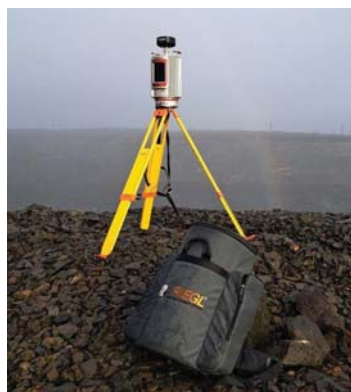
Рис. 1. Лазерный сканер Riegl VZ 4000 с GPS-приемником PRinCE i80
