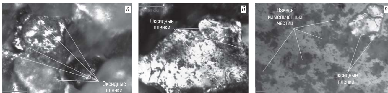
Рис. 7. Микрофотографии частицы рудной пульпы до УЗИ-воздействия (а) и после УЗИ-воздействия продолжительностью 900 с при интенсивности излучения на поверхности излучателя 17,5 (б) и 21 (в) Вт/см 2
