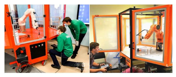
Роботизированная ячейка FANUC используется для подготовки и проведения соревнований по компетенции «Промышленная робототехника» по стандартам WorldSkills и включат в себя 5 модулей.
