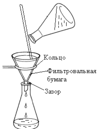
Рис. 31. Правильное расположение воронки и приемника
