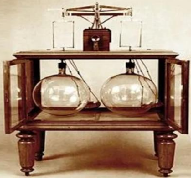
Весы, сконструированные Д. И. Менделеевым для взвешивания газообразных и твёрдых веществ
