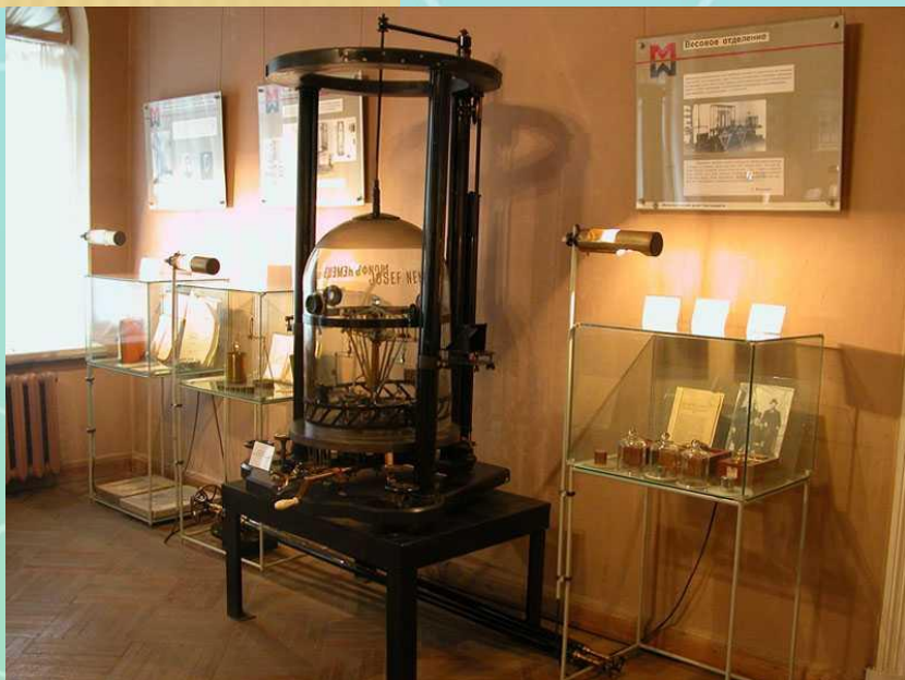
Весы, сконструированные Д. И. Менделеевым для взвешивания газообразных и твёрдых веществ
